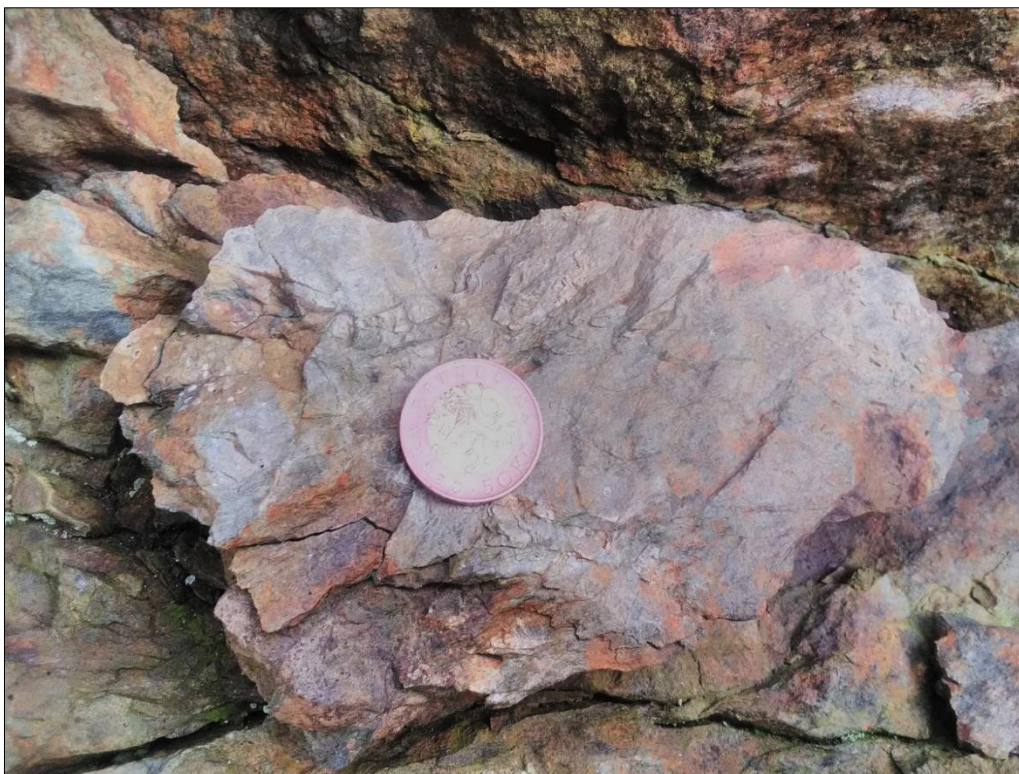
Obr. 19: Detail metamorfovaných drobových břidlic zelenavé barvy ze zářezu železniční trati, střední až silný stupeň zvětrání, výluhy sloučenin železa.
